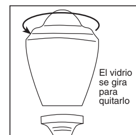
Figura 7 Conjunto de vidrio atornillado
