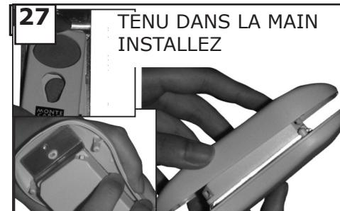
Placez le plat de visage au-dessus du compartiment et des boutons de batterie. Placez l'extérieur plus de 2 bornes sur la couverture. Attachez la couverture de l'extérieur en plaçant plus de 4 bornes et snapping dans l'endroit.
