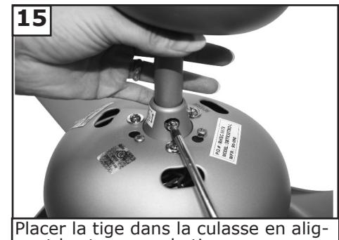
Placer la tige dans la culasse en alignant les trous sur la tige avec ceux de la culasse, puis réinstaller la contre-goupille retirée à l'étape 12. Bien serrer.
